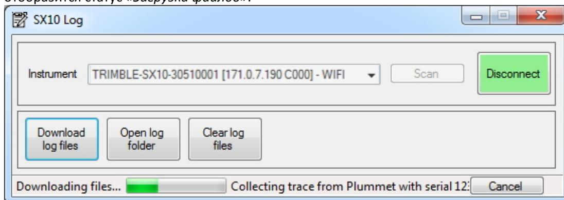
**Внимание!** Не разрывайте и не прерывайте соединение между сканирующим тахеометром Trimble SX10 и планшетным ПК в ходе этого процесса.
